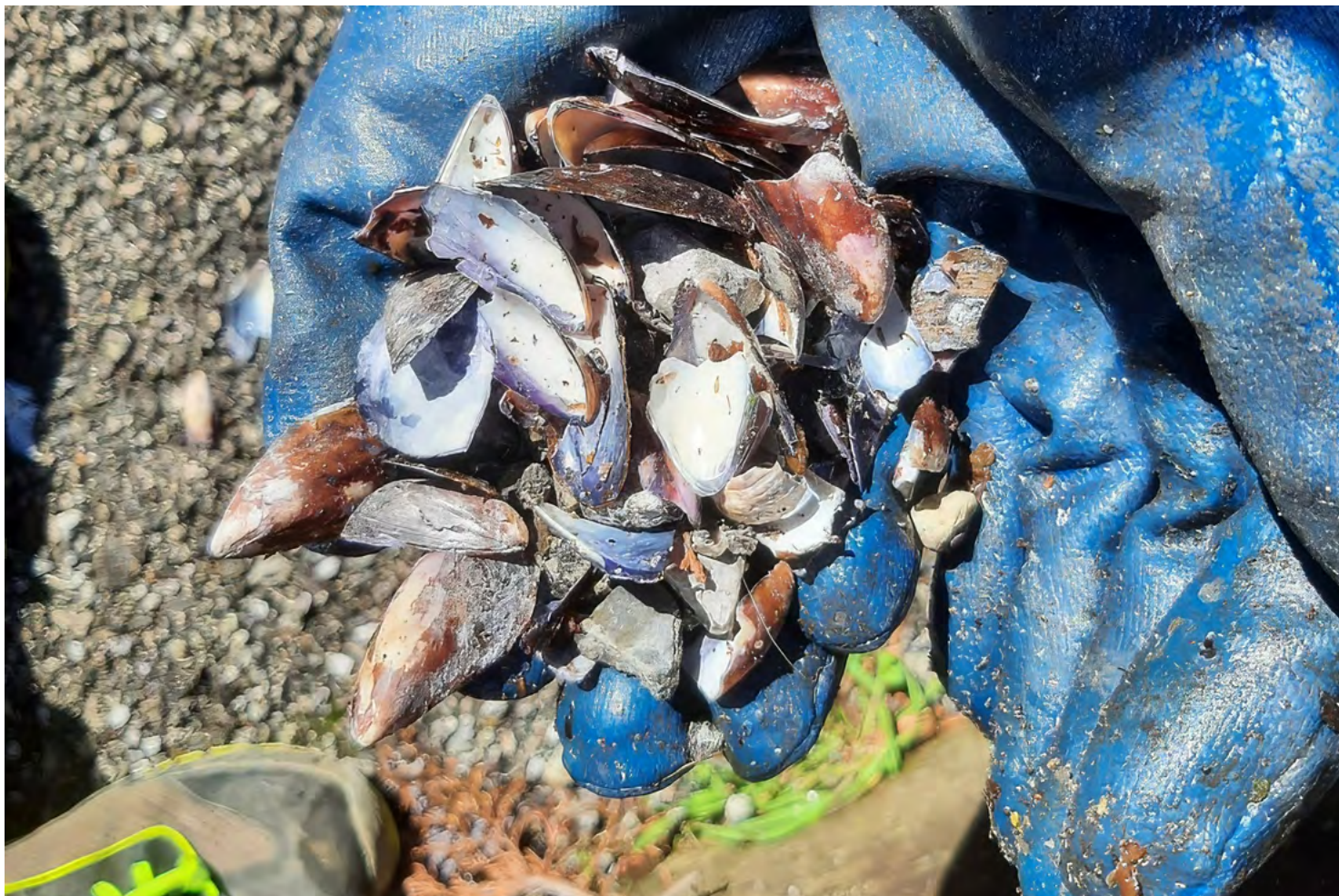
Cozze del biofiltro deodorizzante al depuratore di Bellano. Foto di Samuele Avanzi.
